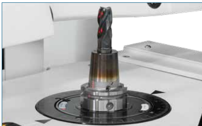
Berührungsloses Messen mit hochauflösender Kamera und digitaler Bildverarbeitung, incl. Messsoftware „Microvision“
